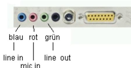
*Achten Sie darauf, dass Sie den richtigen Eingang der Soundkarte verwenden. Bei moderneren PCs gelten die folgenden Farbkodierungen für die Eingänge (S. Abb. 8):*
